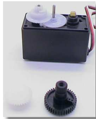
Fig.5- Servo desmontado.
