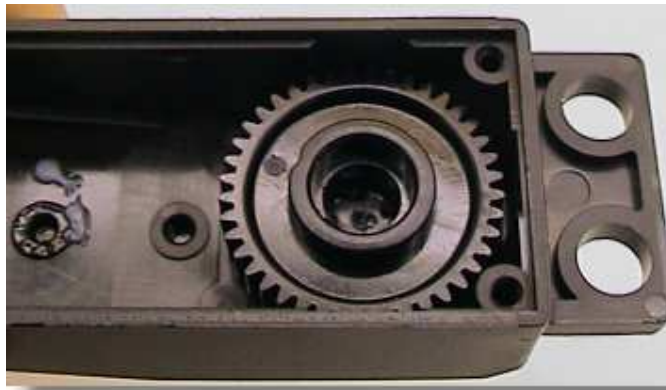
Fig.14-Aspecto final da tampa superior do servo.
