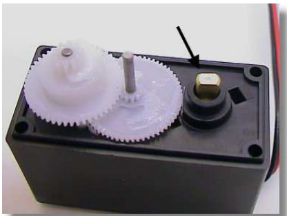
Fig.8- Cortar o potenciômetro.
