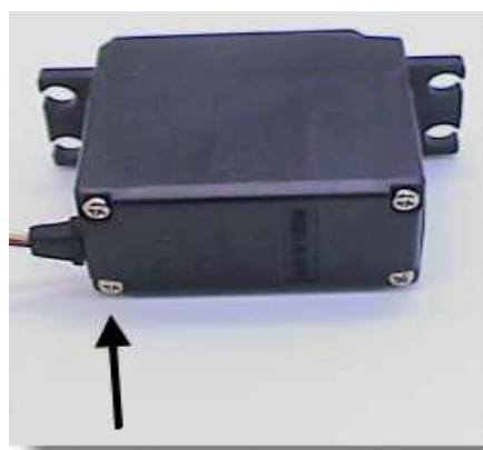
Fig.3- Desaparafusar os parafusos.
