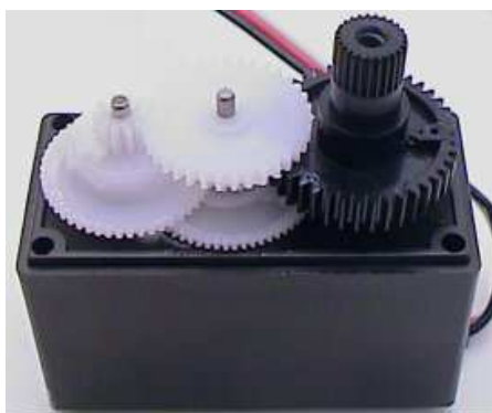
Fig.15-Rodas dentadas colocadas nos sítios.
