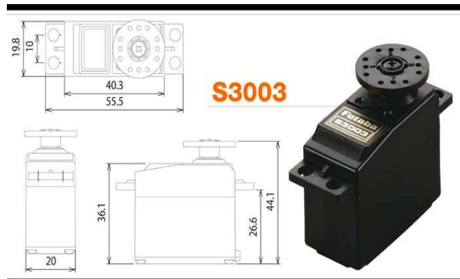
Fig.2- Dimensões do servo.
